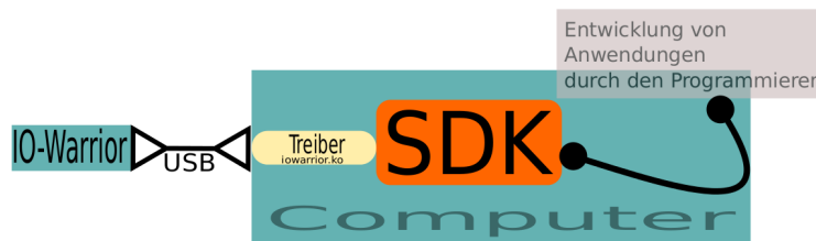
Abbildung 3.1. Das Grundscheema um mit dem IO-Warrior24-Baustein messen, steuern und regeln zu können, bleibt immer gleich. Der Baustein wird über USB mit dem PC verbunden. Ein Programmierer, der Anwendungen für den IO-Warrior erstellen will, greift auf das SDK zu. Das SDK verwendet den Treiber, um mit dem Baustein zu kommunizieren, d.h. Daten zu lesen oder Kommandos zu senden/empfangen.
