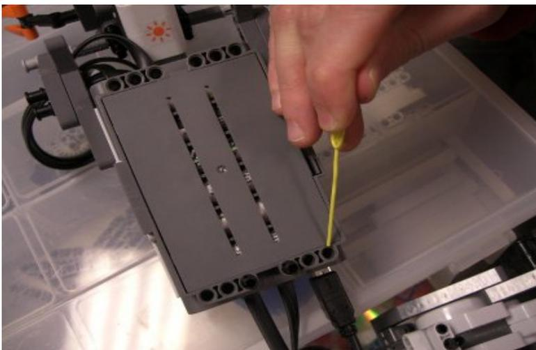
Abbildung 10: Der Resetbutton befindet sich unter dem USB Anschluss in ersten Loch.
