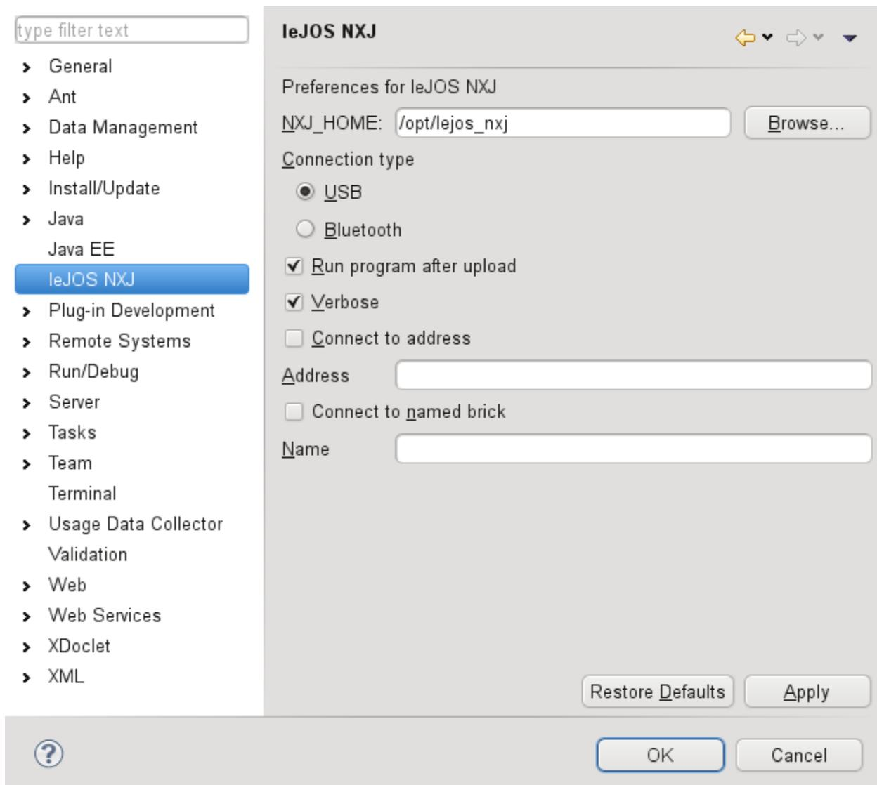
Abbildung 9: Setze NXJ\_HOME: auf */opt/lejos\_nxj* und den Verbindungstyp auf USB.
