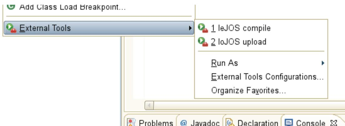
Abbildung 7: Mit 1 leJOS compile und 2 leJOS upload läßt sich nach der Konfiguration bequem programmieren.
