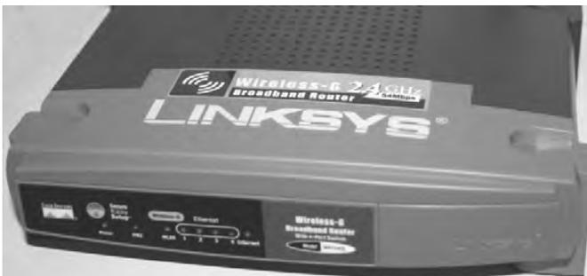
Abb. 2.5: Linksys-Router mit DD-WRT-Linux
